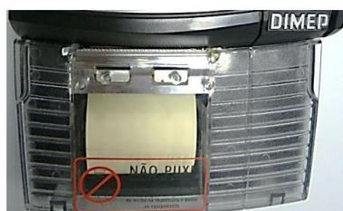
Após a troca é **obrigatória** a utilização da Função 89 Troca de Bobina (conforme item 3.4 deste manual), para indicar quanto atingir Pouco Papel.
