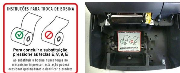
Insira a Bobina de papel no equipamento, e posicione na impressora conforme a imagem abaixo:
